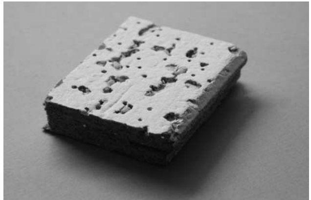
Teil einer asbesthaltigen Akustikplatte, Foto IST
